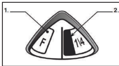
УКАЗАТЕЛЬ УРОВНЯ ТОПЛИВА: 1 – бак полный; 2 – бак пустой
