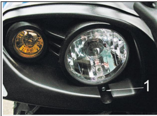
Поверните регулировочный винт (1) по часовой стрелке - чтобы поднять световой пучок фары. Поверните регулировочный винт (1) против часовой стрелки - чтобы поднять световой пучок фары.
