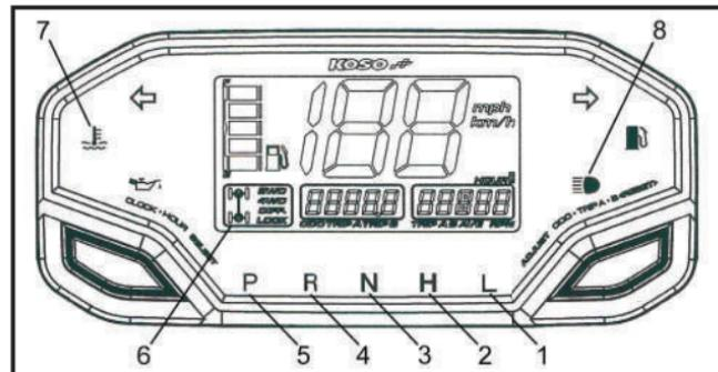
**ПРЕДОСТЕРЕЖЕНИЕ:** Переключайте передачи и режимы только при остановленном снегоболотоходе. Переключение передач и режимов трансмиссии в движении приведет к поломке снегоболотохода.
