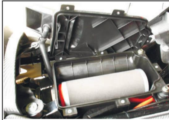
Вставьте новый фильтрующий элемент воздушного фильтра на свое место и установите снятые детали.
