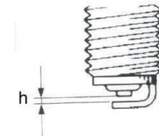
$h$  - Зазор между электродами свечи зажигания.
