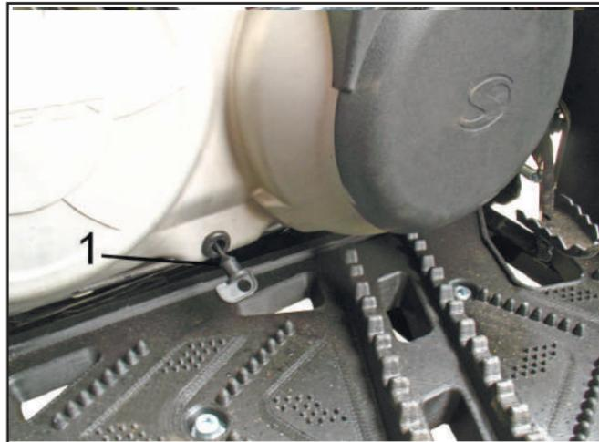
1. Сливная пробка кожуха приводного ремня.
