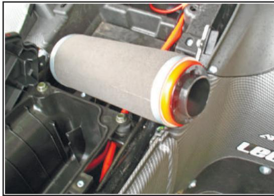
Извлеките использованный фильтрующий элемент.
