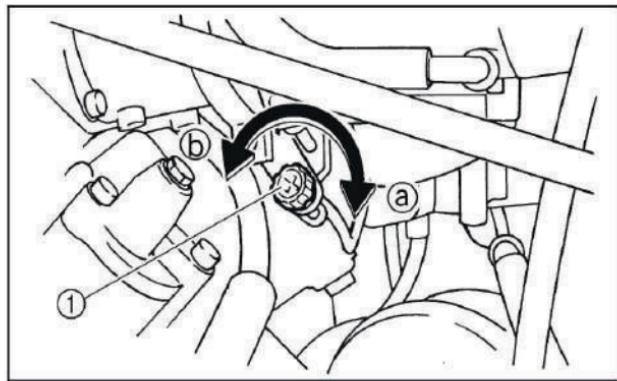
1. Регулировочный винт карбюратора.
