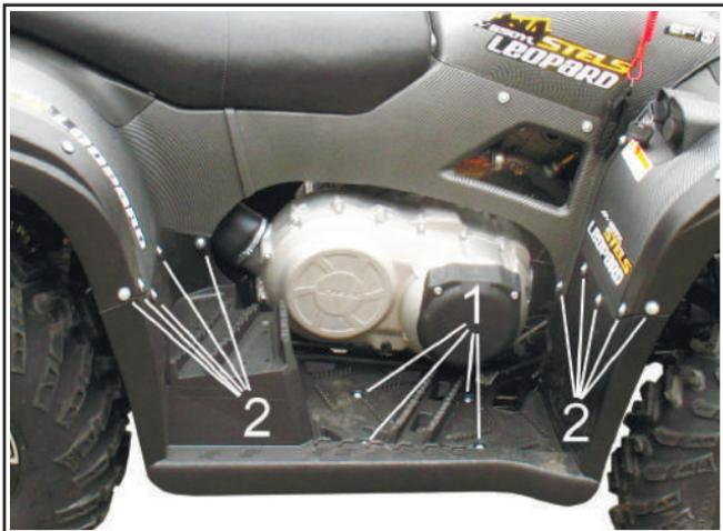
1. Винты крепления опоры для ног к металлическому каркасу.
