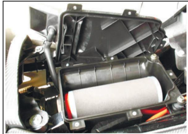
7. Вставьте фильтрующий элемент в корпус воздушного фильтра и закрепите на своем месте крышку.
