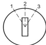
Положение «1» - (зажигание выключено) двигатель и все электроприборы выключены.
