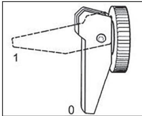
Для пуска холодного двигателя и в начальный период его работы, пока он не прогрет, требуется дополнительное обогащение топливной смеси, то есть увеличение доли бензина в ее составе.
