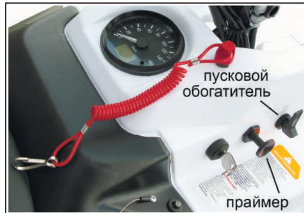
**ПРЕДОСТЕРЕЖЕНИЕ:** Не используйте ручной насос впрыска при запуске и работе прогретого двигателя, а также при пуске холодного двигателя в условиях не очень холодной погоды. Как правило, для запуска двигателя при температуре окружающего воздуха до  $-15^{\circ}\text{C}$  достаточно включения пускового обогатителя.
