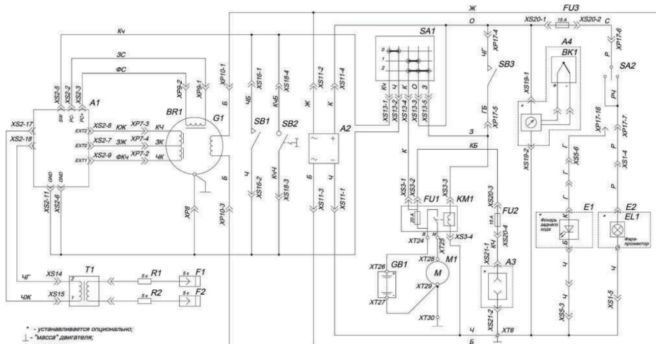
**A1 - Контроллер зажигания; A2 - Регулятор напряжения; A3 - Розетка 12 В; A4 - Индикатор температуры двигателя\***
