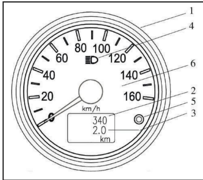
4. Индикатор включения дальнего света . Загорается синим светом при включении фар в режим дальнего света.
