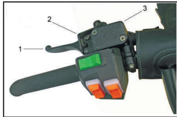
1. Рычаг тормоза. Нажатие на рычаг включает тормозной механизм, при этом загорается лампа сигнала "стоп" в заднем фонаре снегохода. Интенсивность торможения зависит от усилия, прилагаемого к рычагу при торможении. При отпускании рычаг возвращается в исходное положение.
