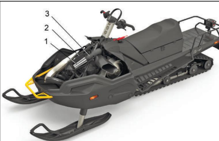
**ПРЕДОСТЕРЕЖЕНИЕ:** Регулярно проверяйте состояние фильтрующего элемента воздухофильтра. В случае движения в сложных погодных условиях (метель, глубокий снег и проч.) возможна потеря мощности двигателя и увеличение расхода топлива из-за обмерзания впускного тракта, препятствующего свободному прохождению воздуха через фильтрующий элемент. В этом случае следует остановиться и прочистить от льда и снега фильтрующий элемент (1) и защитную сетку (4) окна капота.
