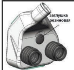
В случае эксплуатации при температурах ниже - 30° С, для исключения повреждения двигателя, необходимо при заглушенном двигателе извлечь из нижнего корпуса воздушного фильтра резиновую заглушку.
