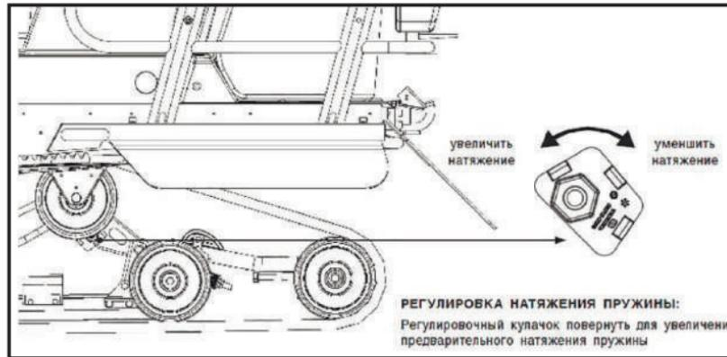
Для увеличения натяжения пружины левый регулировочный кулачок всегда поворачивайте против часовой стрелки, а правый - по часовой стрелке.
