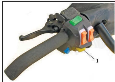
Кратковременно нажмите кнопку реверса – обороты двигателя автоматически снижаются до минимума и коленвал сменит направление вращения в противоположную сторону.
