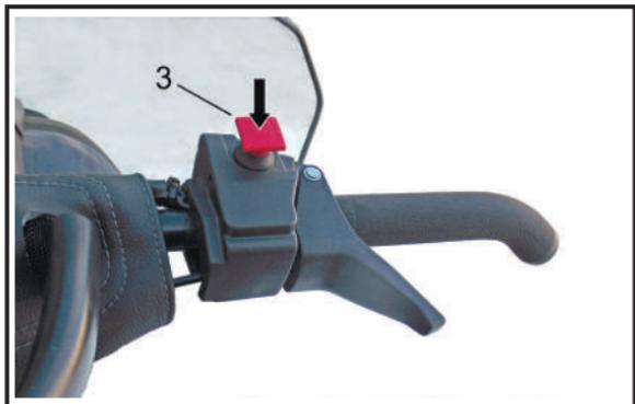
3 – зажигание и электроприборы выключены
