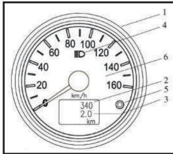
1. Спидометр. Показывает скорость движения снегохода. Единицы измерения - км/час.
