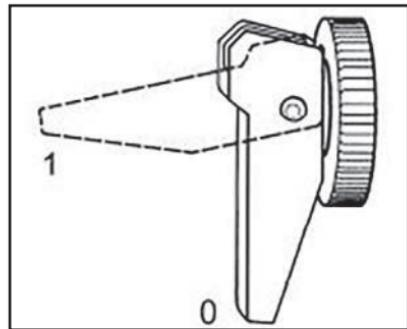
При таком положении планки обогатитель выключен, и карбюраторы обеспечивают приготовление топливной смеси оптимального (для прогретого двигателя) состава.
