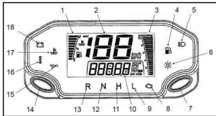
6. Индикатор включения освещения, загорается зеленым цветом при включении фары дальнего света.
