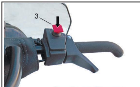
3 – зажигание и электроприборы выключены
