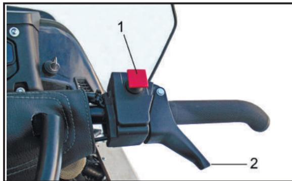
1. - кнопка экстренного выключения зажигания имеет два фиксированных положения. Нажатием на кнопку выключается система зажигания и двигатель выключается.
