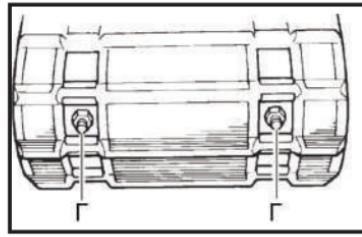
Поэтому обе регулировки должны проводиться одновременно. Перед проведением операций регулировки натяжения и выравнивания гусениц рекомендуем на наружные поверхности приводных колес и на пластиковые накладки направляющих задней подвески в местах соприкосновения с гусеницей нанести силиконовую смазку.
